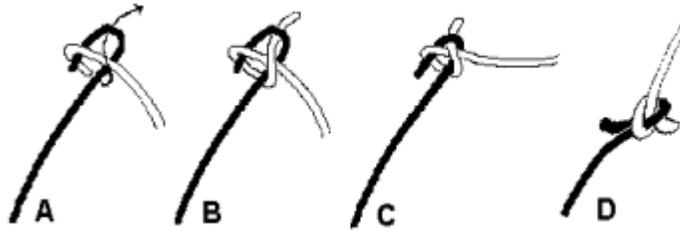
El nudo de "Vuelta de Escota" es utilizado comúnmente para unir dos cuerdas de diferente mena (distinto grosor). Tal como se aprecia en la figura, se elabora haciendo una pequeña 'U' en la punta de una de las cuerdas y luego se envuelve con la otra, que se aprieta a sí misma.
